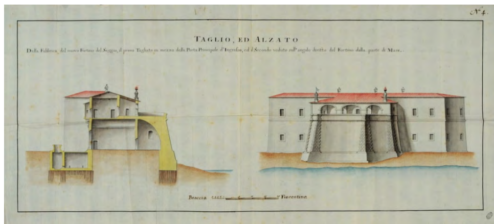
Fig. 3- Taglio, ed alzato della fabbrica del nuovo fortino del Seggio , ASFi, Scrittoio delle Fortezze e Fabbriche. Fabbriche Lorenese , n. 2000, fasc. 30, c.n.n. (Giovanni Mori, 1783).
