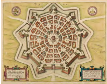
Fig. 12 The enneagonal plan of Palmanova, designed in 1593 by Vincenzo Scamozzi, 1598 (Biblioteca Nazionale Marciana di Venezia).
