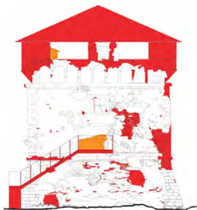
Fig. 7- Risarcimenti, rifacimenti, demolizioni.
